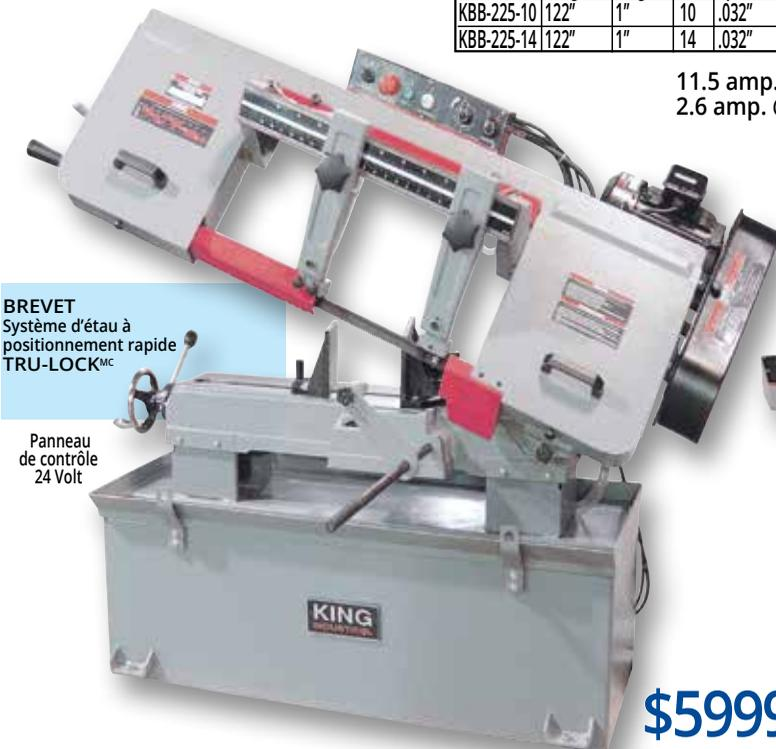
BREVET Système d'étau à positionnement rapide TRU-LOCK<sup>MC</sup>
